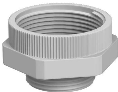
Espansione con filettatura interna ed esterna metrica per il montaggio di pressacavi in plastica in alloggiamenti. Grado di protezione IP54 senza guarnizione di collegamento supplementare. Possibile grado di protezione fino a IP68 con guarnizione di collegamento supplementare, ad esempio O-ring o guarnizione circolare piatta.
