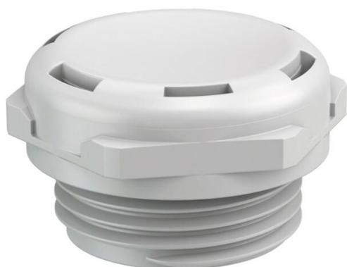
L'elemento di compensazione della pressione del tipo 109 M20 LGR compensa le differenze di pressione nelle scatole di derivazione, nei ripartitori piccoli e nelle scatole di derivazione con apertura M20 ed evita la formazione di acqua di condensa negli alloggiamenti stagni. L'elemento di compensazione della pressione in poliammide ha il grado di protezione IP68/IP69, che permane anche dopo l'installazione dell'elemento. È adatto per l'uso negli ambienti industriali e negli ambienti esterni.
