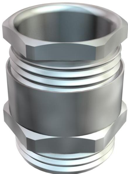
Pressacavo con adattatore esagonale, forma C4 secondo DIN 46320 con raccordo filettato metrico secondo DIN EN 60423 o ISO 68. Guarnizione in acciaio, zincato galvanicamente e passivato trasparente. Guarnizione interna in NR/SBR.
