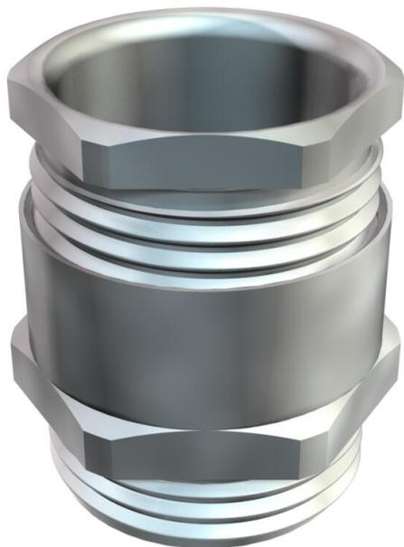
Pressacavo con connettore intermedio esagonale, forma C4 secondo DIN 46320 con raccordo filettato PG secondo DIN 40430.
