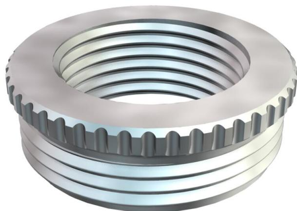
Riduzione (Parte H) secondo DIN 46320, con filettatura PG secondo DIN 40430, per il passaggio da un foro filettato PG ad un pressacavo di dimensioni inferiori.
