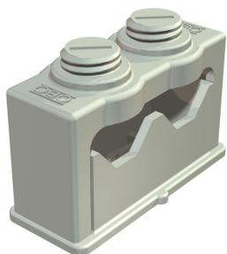
Gaffetta accoppiabile ad innesto ISO, 1 via, per il fissaggio individuale di cavi . Possibilità di fissaggio tramite base adesiva o vite con filettatura M6. Per il fissaggio su strutture in muratura e calcestruzzo utilizzare la colla a presa rapida Impu-Fix tipo 509.
