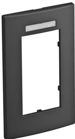
Coperchio con aggancio frontale per apparecchi da incasso Modul 45, 1x, con campo di siglatura per installazioni apparecchi verticali, per il fissaggio su scatola da incasso 71GD13 o in supporti di montaggio 71MT2 45. Per l'installazione in canali incasso Rapid 80 e colonne ISS.
