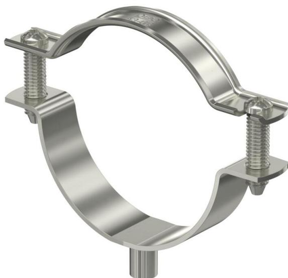
Collare di fissaggio per il montaggio di tubi e cavi a parete, soffitto e pavimento. Con elemento superiore autobloccante. Fissaggio sopra supporto con filettatura interna.
