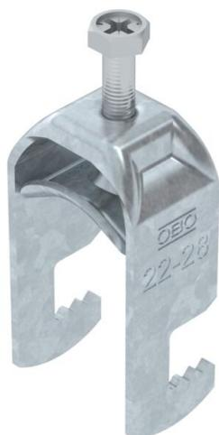
Staffa reggicavo con ancoraggio tipo F, coppa in metallo con bordi arrotondati a protezione del cavo. Per il montaggio verticale e orizzontale di 1 cavo singolo su profilato piatto. Dotata di vite SW10 per il serraggio della coppa tramite testa esagonale o intaglio a croce. Per il montaggio in ambiente interno ed esterno. Si raccomanda l'uso della controcoppa, da ordinare separatamente.
