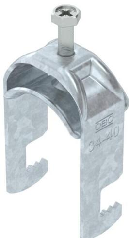
Staffa reggicavo con ancoraggio tipo F, coppa in metallo con bordi arrotondati a protezione del cavo. Per il montaggio verticale e orizzontale di 1 cavo singolo su profilato piatto. Dotata di vite SW10 per il serraggio della coppa tramite testa esagonale o intaglio a croce. Per il montaggio in ambiente interno ed esterno. Si raccomanda l'uso della controcoppa, da ordinare separatamente.
