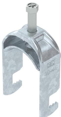
Staffa reggicavo con ancoraggio tipo F, coppa in metallo con bordi arrotondati a protezione del cavo. Per il montaggio verticale e orizzontale di 1 cavo singolo su profilato piatto. Dotata di vite SW10 per il serraggio della coppa tramite testa esagonale o intaglio a croce. Per il montaggio in ambiente interno ed esterno. Si raccomanda l'uso della controcoppa, da ordinare separatamente.
