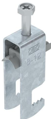
Staffa reggicavo con ancoraggio tipo F, coppa plastica in polipropilene. Per il montaggio verticale e orizzontale di 1 cavo singolo su profilato piatto. Dotata di vite SW10 per il serraggio della coppa tramite testa esagonale o intaglio a croce. Per il montaggio in ambiente interno ed esterno.
