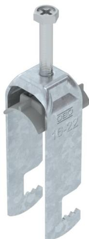
Staffa reggicavo con ancoraggio tipo F, coppa plastica in polipropilene. Per il montaggio verticale e orizzontale di 1 cavo singolo su profilato piatto. Dotata di vite SW10 per il serraggio della coppa tramite testa esagonale o intaglio a croce. Per il montaggio in ambiente interno ed esterno.
