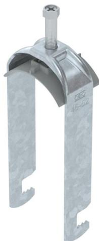
Staffa reggicavo con ancoraggio tipo F, coppa plastica in polipropilene. Per il montaggio verticale e orizzontale di 1 cavo singolo su profilato piatto. Dotata di vite SW10 per il serraggio della coppa tramite testa esagonale o intaglio a croce. Per il montaggio in ambiente interno ed esterno.
