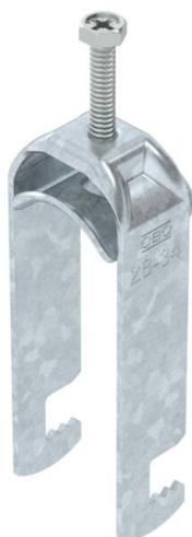
Staffa reggicavo ancoraggio tipo F, coppa in metallo con bordi arrotondati per proteggere il cavo. Per il montaggio verticale e orizzontale di 2 cavi singoli su profilato piatto. Con coppa di pressione, testa a vite esagonale universale SW10, intaglio a croce e a taglio. Per il montaggio in ambiente interno ed esterno. Separazione tra due cavi grazie alla coppa doppia. Si raccomanda l'uso della contro-coppa.
