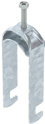
Staffa reggicavo ancoraggio tipo F, coppa in metallo con bordi arrotondati per proteggere il cavo. Per il montaggio verticale e orizzontale di 2 cavi singoli su profilato piatto. Con coppa di pressione, testa a vite esagonale universale SW10, intaglio a croce e a taglio. Per il montaggio in ambiente interno ed esterno. Separazione tra due cavi grazie alla coppa doppia. Si raccomanda l'uso della contro-coppa.
