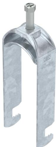
Staffa reggicavo ancoraggio tipo F, coppa in metallo con bordi arrotondati per proteggere il cavo. Per il montaggio verticale e orizzontale di 2 cavi singoli su profilato piatto. Con coppa di pressione, testa a vite esagonale universale SW10, intaglio a croce e a taglio. Per il montaggio in ambiente interno ed esterno. Separazione tra due cavi grazie alla coppa doppia. Si raccomanda l'uso della contro-coppa.
