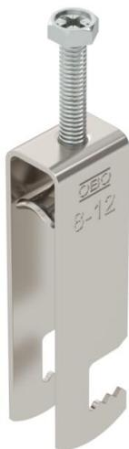
Staffa reggicavo ancoraggio tipo F, coppa in metallo con bordi arrotondati per proteggere il cavo. Per il montaggio verticale e orizzontale di 3 cavi singoli su profilato piatto. Con 1 vite a pressione, testa a vite esagonale universale SW10, con fessura e taglio a croce. Per il montaggio in ambienti interni ed esterni. Separazione tra due cavi grazie alla coppa doppia. Si consiglia di utilizzare una controcoppa.
