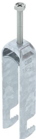
Staffa reggicavo ancoraggio tipo F, coppa in metallo con bordi arrotondati per proteggere il cavo. Per il montaggio verticale e orizzontale di 3 cavi singoli su profilato piatto. Con 1 vite a pressione, testa a vite esagonale universale SW10, con fessura e taglio a croce. Per il montaggio in ambienti interni ed esterni. Separazione tra due cavi grazie alla coppa doppia. Si consiglia di utilizzare una controcoppa.
