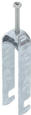
Staffa reggicavo ancoraggio tipo F, coppa in metallo con bordi arrotondati per proteggere il cavo. Per il montaggio verticale e orizzontale di 3 cavi singoli su profilato piatto. Con 1 vite a pressione, testa a vite esagonale universale SW10, con fessura e taglio a croce. Per il montaggio in ambienti interni ed esterni. Separazione tra due cavi grazie alla coppa doppia. Si consiglia di utilizzare una controcoppa.
