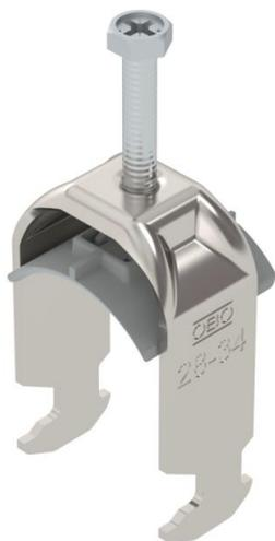
Staffa reggicavo con ancoraggio tipo H, coppa plastica in polipropilene. Per il montaggio verticale e orizzontale di 1 cavo singolo su profilato a C con scanalatura di larghezza 16 - 17 mm. Dotata di vite SW10 per il serraggio della coppa tramite testa esagonale o intaglio a croce. Per il montaggio in ambiente interno ed esterno. Si raccomanda l'uso della controcoppa, da ordinare separatamente.
