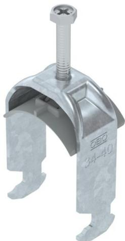
Staffa reggicavo con ancoraggio tipo H, coppa plastica in polipropilene. Per il montaggio verticale e orizzontale di 1 cavo singolo su profilato a C con scanalatura di larghezza 16 - 17 mm. Dotata di vite SW10 per il serraggio della coppa tramite testa esagonale o intaglio a croce. Per il montaggio in ambiente interno ed esterno. Si raccomanda l'uso della controcoppa, da ordinare separatamente.
