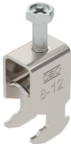
Staffa reggicavo con base a testa di martello, coppa in metallo con bordi arrotondati per la protezione del cavo. Per il montaggio verticale e orizzontale di 1 cavo singolo su profilato a C. Per dimensioni dell'asola di 16-17 mm. Con 1 vite a pressione, testa a vite esagonale universale SW10, con fessura e taglio a croce. Per il montaggio in ambienti interni ed esterni. Si consiglia di utilizzare una controcoppa.
