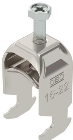
Staffa reggicavo con base a testa di martello, coppa in metallo con bordi arrotondati per la protezione del cavo. Per il montaggio verticale e orizzontale di 1 cavo singolo su profilato a C. Per dimensioni dell'asola di 16-17 mm. Con 1 vite a pressione, testa a vite esagonale universale SW10, con fessura e taglio a croce. Per il montaggio in ambienti interni ed esterni. Si consiglia di utilizzare una controcoppa.
