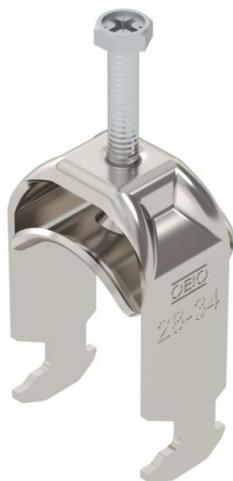
Staffa reggicavo con ancoraggio tipo H, coppa in metallo con bordi arrotondati a protezione del cavo. Per il montaggio verticale e orizzontale di 1 cavo singolo su profilato a C con scanalatura di larghezza 16 - 17 mm. Dotata di vite SW10 per il serraggio della coppa tramite testa esagonale o intaglio a croce. Per il montaggio in ambiente interno ed esterno. Si raccomanda l'uso della controcoppa, da ordinare separatamente.
