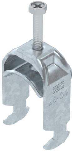
Staffa reggicavo con base a testa di martello, coppa in metallo con bordi arrotondati per la protezione del cavo. Per il montaggio verticale e orizzontale di 1 cavo singolo su profilato a C. Per dimensioni scanalatura di 16-17 mm. Con coppa di pressione, testa a vite esagonale universale SW10, intaglio a croce e a taglio. Per il montaggio in ambiente interno ed esterno. La controcoppa deve essere ordinata separatamente.
