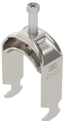
Staffa reggicavo con ancoraggio tipo H, coppa in metallo con bordi arrotondati a protezione del cavo. Per il montaggio verticale e orizzontale di 1 cavo singolo su profilato a C con scanalatura di larghezza 16 - 17 mm. Dotata di vite SW10 per il serraggio della coppa tramite testa esagonale o intaglio a croce. Per il montaggio in ambiente interno ed esterno. Si raccomanda l'uso della controcoppa, da ordinare separatamente.
