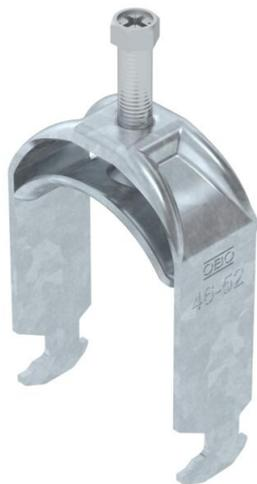
Staffa reggicavo con base a testa di martello, coppa in metallo con bordi arrotondati per la protezione del cavo. Per il montaggio verticale e orizzontale di 1 cavo singolo su profilato a C. Per dimensioni scanalatura di 16-17 mm. Con coppa di pressione, testa a vite esagonale universale SW10, intaglio a croce e a taglio. Per il montaggio in ambiente interno ed esterno. La controcoppa deve essere ordinata separatamente.
