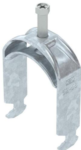
Staffa reggicavo con base a testa di martello, coppa in metallo con bordi arrotondati per la protezione del cavo. Per il montaggio verticale e orizzontale di 1 cavo singolo su profilato a C. Per dimensioni dell'asola di 16-17 mm. Con 1 vite a pressione, testa a vite esagonale universale SW10, con fessura e taglio a croce. Per il montaggio in ambienti interni ed esterni. Si consiglia di utilizzare una controcoppa.
