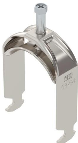
Staffa reggicavo con ancoraggio tipo H, coppa in metallo con bordi arrotondati a protezione del cavo. Per il montaggio verticale e orizzontale di 1 cavo singolo su profilato a C con scanalatura di larghezza 16 - 17 mm. Dotata di vite SW10 per il serraggio della coppa tramite testa esagonale o intaglio a croce. Per il montaggio in ambiente interno ed esterno. Si raccomanda l'uso della controcoppa, da ordinare separatamente.
