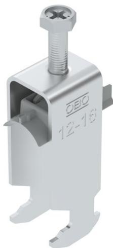
Staffa reggicavo con ancoraggio tipo H, coppa plastica in polipropilene. Per il montaggio verticale e orizzontale di 2 cavi singoli su profilato a C con scanalatura di larghezza 16 - 17 mm. Dotata di vite SW10 per il serraggio della coppa tramite testa esagonale o intaglio a croce. Per il montaggio in ambiente interno ed esterno. Separazione tra due cavi garantita dalla coppa doppia. Si raccomanda l'uso della controcoppa, da ordinare separatamente.
