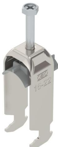
Staffa reggicavo con ancoraggio a testa di martello, coppa in plastica in polipropilene. Per il montaggio verticale e orizzontale di 2 cavi singoli su profilato a C. Per dimensioni scanalatura di 16-17 mm. Con 1 vite a pressione, testa a vite esagonale universale SW10, con fessura e taglio a croce. Per il montaggio in ambienti interni ed esterni. Separazione tra due cavi grazie alla coppa doppia. Si consiglia di utilizzare una controcoppa.
