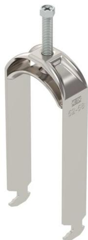
Staffa reggicavo con base a testa di martello, coppa in metallo con bordi arrotondati per la protezione del cavo. Per il montaggio verticale e orizzontale di 2 cavi singoli su profilato a C. Per dimensioni scanalatura di 16-17 mm. Con coppa di pressione, testa a vite esagonale universale SW10, intaglio a croce e a taglio. Per il montaggio in ambienti interni ed esterni. Separazione tra due cavi grazie alla coppa doppia. Si raccomanda l'uso della controcoppa.
