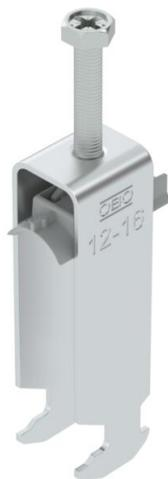
Staffa reggicavo con ancoraggio tipo H, coppa plastica in polipropilene. Per il montaggio verticale e orizzontale di 3 cavi singoli su profilato a C con scanalatura di larghezza 16 - 17 mm. Dotata di vite SW10 per il serraggio della coppa tramite testa esagonale o intaglio a croce. Per il montaggio in ambiente interno ed esterno. Separazione tra due cavi garantita dalla coppa doppia. Si raccomanda l'uso della controcoppa, da ordinare separatamente.
