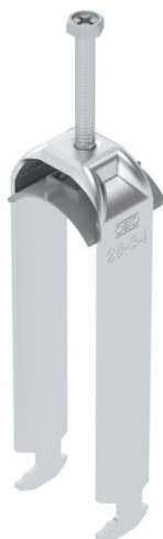
Staffa reggicavo con ancoraggio tipo H, coppa plastica in polipropilene. Per il montaggio verticale e orizzontale di 3 cavi singoli su profilato a C con scanalatura di larghezza 16 - 17 mm. Dotata di vite SW10 per il serraggio della coppa tramite testa esagonale o intaglio a croce. Per il montaggio in ambiente interno ed esterno. Separazione tra due cavi garantita dalla coppa doppia. Si raccomanda l'uso della controcoppa, da ordinare separatamente.
