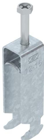
Staffa reggicavo con ancoraggio tipo H, coppa plastica in polipropilene. Per il montaggio verticale e orizzontale di 3 cavi singoli su profilato a C con scanalatura di larghezza 16 - 17 mm. Dotata di vite SW10 per il serraggio della coppa tramite testa esagonale o intaglio a croce. Per il montaggio in ambiente interno ed esterno. Separazione tra due cavi garantita dalla coppa doppia. Si raccomanda l'uso della controcoppa, da ordinare separatamente.
