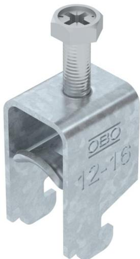
Staffa reggicavo con ancoraggio tipo N, coppa in metallo con bordi arrotondati a protezione del cavo. Per il montaggio verticale e orizzontale di 1 cavo singolo su profilato a C con scanalatura di larghezza 11 - 12 mm. Dotata di vite SW10 per il serraggio della coppa tramite testa esagonale o intaglio a croce. Per il montaggio in ambiente interno ed esterno. Si raccomanda l'uso della controcoppa, da ordinare separatamente.
