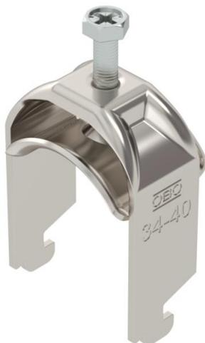
Staffa reggicavo con ancoraggio tipo N, coppa in metallo con bordi arrotondati per proteggere il cavo. Per il montaggio verticale e orizzontale di 1 cavo singolo su profilato a C. Per asola 11 - 12 mm. Con coppa di pressione, testa a vite esagonale universale SW10, intaglio a croce e a taglio. Per il montaggio in ambiente interno ed esterno. Si raccomanda l'uso della controcoppa.
