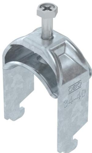
Staffa reggicavo con ancoraggio tipo N, coppa in metallo con bordi arrotondati a protezione del cavo. Per il montaggio verticale e orizzontale di 1 cavo singolo su profilato a C con scanalatura di larghezza 11 - 12 mm. Dotata di vite SW10 per il serraggio della coppa tramite testa esagonale o intaglio a croce. Per il montaggio in ambiente interno ed esterno. Si raccomanda l'uso della controcoppa, da ordinare separatamente.
