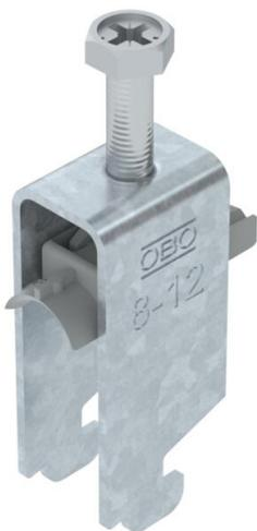
Staffa reggicavo con ancoraggio tipo N, coppa plastica in polipropilene. Per il montaggio verticale e orizzontale di 2 cavi singoli su profilato a C con scanalatura di larghezza 11 - 12 mm. Dotata di vite SW10 per il serraggio della coppa tramite testa esagonale o intaglio a croce. Per il montaggio in ambiente interno ed esterno. Separazione tra due cavi garantita dalla coppa doppia. Si raccomanda l'uso della controcoppa, da ordinare separatamente.
