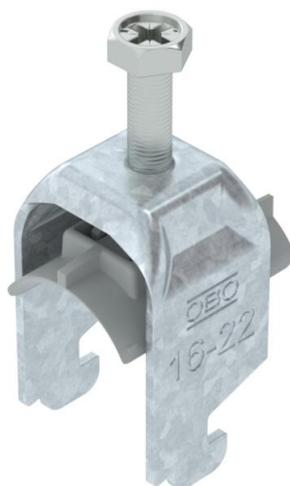
Staffa reggicavo con ancoraggio tipo N, coppa plastica in polipropilene. Per il montaggio verticale e orizzontale di 2 cavi singoli su profilato a C con scanalatura di larghezza 11 - 12 mm. Dotata di vite SW10 per il serraggio della coppa tramite testa esagonale o intaglio a croce. Per il montaggio in ambiente interno ed esterno. Separazione tra due cavi garantita dalla coppa doppia. Si raccomanda l'uso della controcoppa, da ordinare separatamente.
