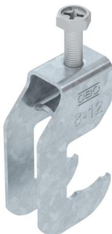
Staffa reggicavo con ancoraggio tipo RS, coppa premente in metallo con bordi arrotondati per proteggere il cavo. Per il montaggio verticale e orizzontale di 1 cavo singolo su profilati tondi o su tubi. Con vite a pressione, testa a vite esagonale universale SW10, con fessura e taglio a croce. Adatta per tutti i profilati tondi o tubi dal diametro fino a 22 mm. Per il montaggio in ambienti interni ed esterni. Si consiglia di utilizzare una controcoppa.
