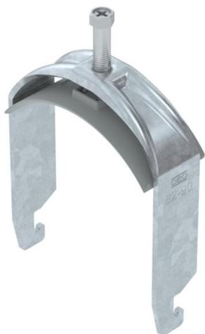
Staffa reggicavo con ancoraggio tipo U, coppa plastica in polipropilene. Per il montaggio verticale e orizzontale di 1 cavo singolo su profilato a C con scanalatura di larghezza 18 - 22 mm. Dotata di vite SW10 per il serraggio della coppa tramite testa esagonale o intaglio a croce. Per il montaggio in ambiente interno ed esterno. Separazione dei due cavi garantiti dalla coppa doppia. Si raccomanda l'uso della controcoppa, da ordinare separatamente.
