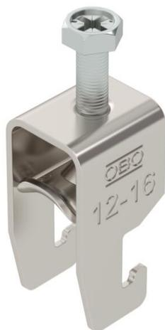
Staffa reggicavo con base a U, coppa in metallo con bordi arrotondati per proteggere il cavo. Per il montaggio verticale e orizzontale di 1 cavo singolo su profilato a C. Per dimensioni dell'asola di 18-22 mm. Con 1 vite a pressione, testa a vite esagonale universale SW10, con fessura e taglio a croce. Per il montaggio in ambienti interni ed esterni. Si consiglia di utilizzare una controcoppa.
