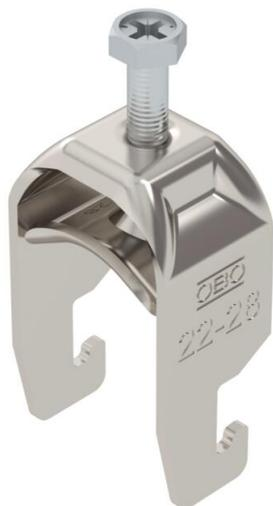
Staffa reggicavo con ancoraggio tipo U, coppa in metallo con bordi arrotondati a protezione del cavo. Per il montaggio verticale e orizzontale di 1 cavo singolo su profilato a C con scanalatura di larghezza 18 - 22 mm. Dotata di vite SW10 per il serraggio della coppa tramite testa esagonale o intaglio a croce. Per il montaggio in ambiente interno ed esterno. Si raccomanda l'uso della controcoppa, da ordinare separatamente.
