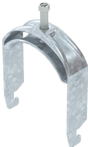
Staffa reggicavo con ancoraggio tipo U, coppa in metallo con bordi arrotondati a protezione del cavo. Per il montaggio verticale e orizzontale di 1 cavo singolo su profilato a C con scanalatura di larghezza 18 - 22 mm. Dotata di vite SW10 per il serraggio della coppa tramite testa esagonale o intaglio a croce. Per il montaggio in ambiente interno ed esterno. Si raccomanda l'uso della controcoppa, da ordinare separatamente.
