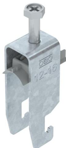
Staffa reggicavo con ancoraggio tipo U, coppa plastica in polipropilene. Per il montaggio verticale e orizzontale di 2 cavi singoli su profilato a C con scanalatura di larghezza 18 - 22 mm. Dotata di vite SW10 per il serraggio della coppa tramite testa esagonale o intaglio a croce. Per il montaggio in ambiente interno ed esterno. Separazione tra due cavi garantita dalla coppa doppia. Si raccomanda l'uso della controcoppa, da ordinare separatamente.
