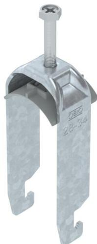
Staffa reggicavo con ancoraggio tipo U, coppa plastica in polipropilene. Per il montaggio verticale e orizzontale di 2 cavi singoli su profilato a C con scanalatura di larghezza 18 - 22 mm. Dotata di vite SW10 per il serraggio della coppa tramite testa esagonale o intaglio a croce. Per il montaggio in ambiente interno ed esterno. Separazione tra due cavi garantita dalla coppa doppia. Si raccomanda l'uso della controcoppa, da ordinare separatamente.
