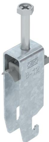
Staffa reggicavo con ancoraggio tipo U, coppa plastica in polipropilene. Per il montaggio verticale e orizzontale di 3 cavi singoli su profilato a C con scanalatura di larghezza 18 mm o 22 mm. Dotata di vite SW10 per il serraggio della coppa tramite testa esagonale o intaglio a croce. Per il montaggio in ambiente interno ed esterno. Separazione tra due cavi garantita dalla coppa doppia. Si raccomanda l'uso della controcoppa, da ordinare separatamente.
