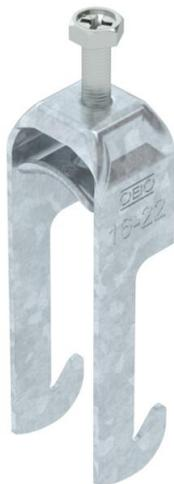
Staffa reggicavo con base a W, coppa in metallo con bordi arrotondati per proteggere il cavo. Per il montaggio verticale e orizzontale di 1 cavo singolo su profilati angolari fino a < 40 mm. Con 1 vite a pressione, testa a vite esagonale universale SW10, con fessura e taglio a croce. Per il montaggio in ambienti interni ed esterni. Si consiglia di utilizzare una controcoppa.
